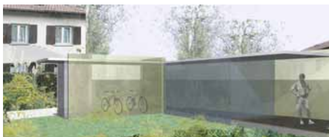
Ein genügend langer Velounterstand mit massiver, dichter Rückwand kann die Aufgabe einer Lärmschutzwand übernehmen.
